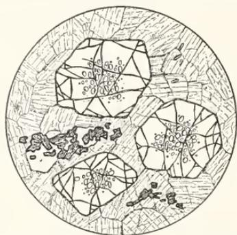
Fig. 11. Eklogit. Fattigau, Fichtelgebirge. Große, einschlußreiche Granate, Omphacit (reich an Splattrissen), Rutil (dunkel). Vergrößerung 15.
