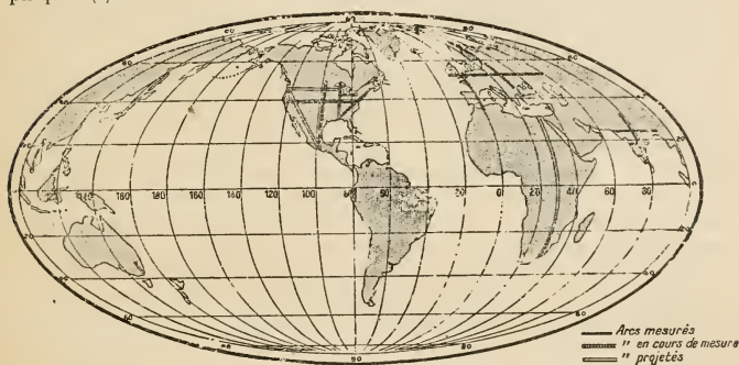
Fig. 1. — Principaux arcs méridiens, parallèles ou obliques, mesurés, ou en projet, à la surface du globe.
