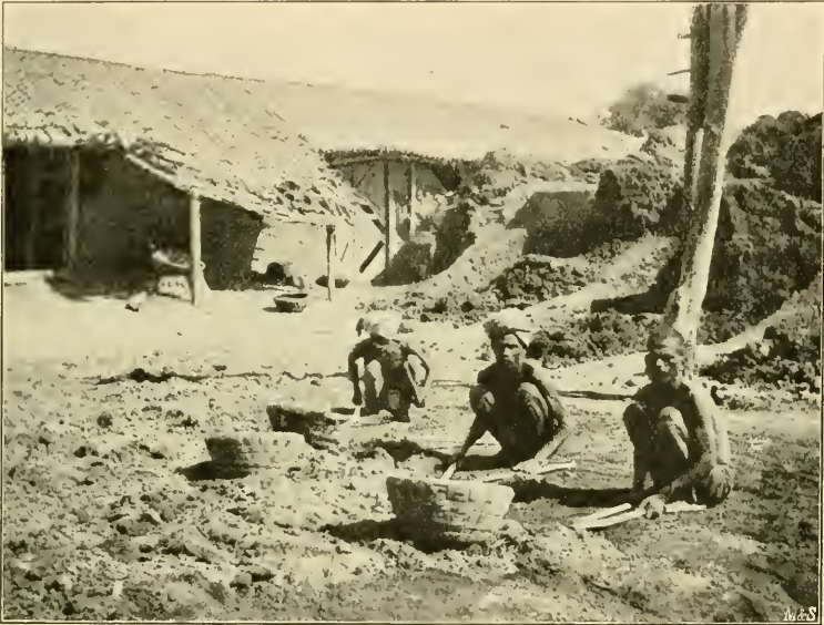
Bild 7. Kulis zerkleinern Erde zur Extraktion von Salpeter. Patna.
