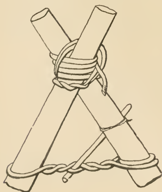
FIG. 80. — Brèlage avec garrotture pour pièces en croix de Saint-André.
