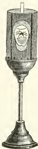
FIG. 1. — L'appareil fontionne, on remarque l'embryon d'un œuf de cinq jours d'incubation.
