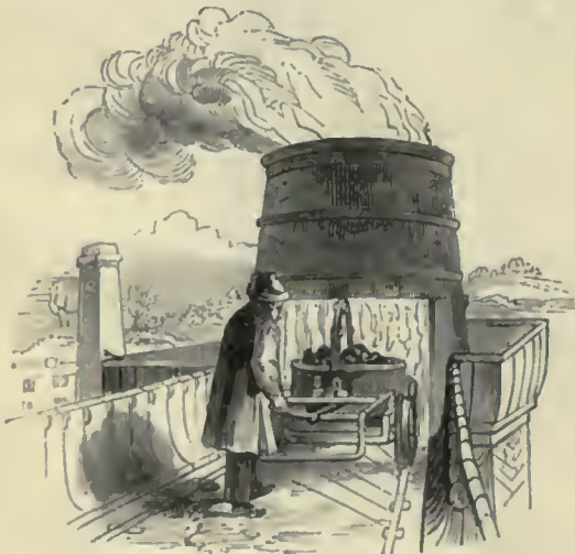
Fig. 3.—Filling Blast Furnace.
