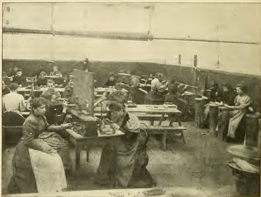
Fig. 2. — Fabrication des filières. — Au premier plan, des ouvrières vérifient au microscope l'épaisseur des différents tubes. Au second plan, d'autres ouvrières les ajustent. (D'après une photographie de M. Mauvillier.)
