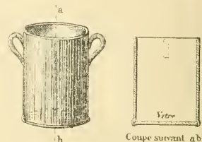
Fig. 4. — Tube d'eau servant à explorer le fond de la mer.
