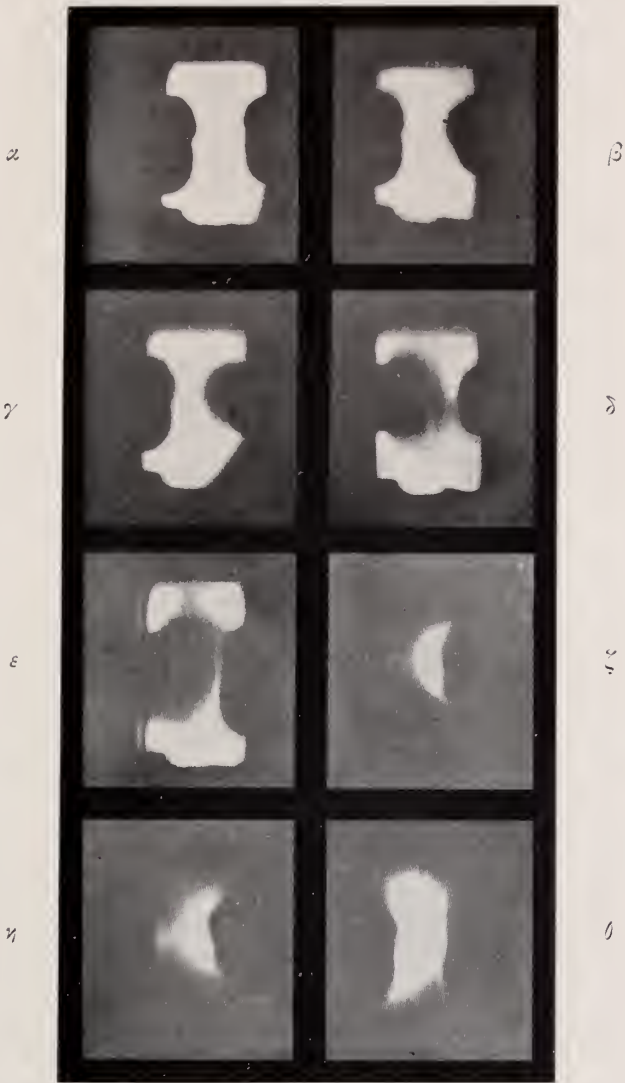
Gradients de densité dans la vapeur de sodium, montrés par le spectrohéliographe.
