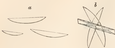
Fig. 56. Vergr. 400 mal. a Kristalle, b Kristallaggregate aus einem geringen (noch nicht völlig amorph gewordenen) Kolophonium.
