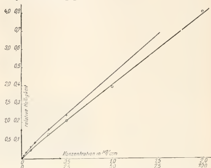
Abb. 3. Abhängigkeit der Fluoreszenz alkalischer Fluoreszenzlösungen von der Konzentration. + einfacher Maßstab. o fünffacher Maßstab.
