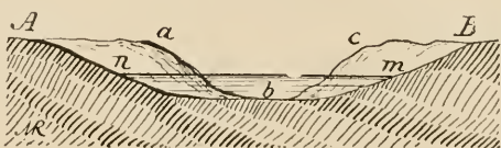
Fig. 15. — Coupe en long d'un gué.
