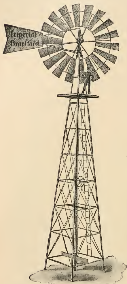
FIG. 598. — Moulin à vent monté sur pylône métallique.
