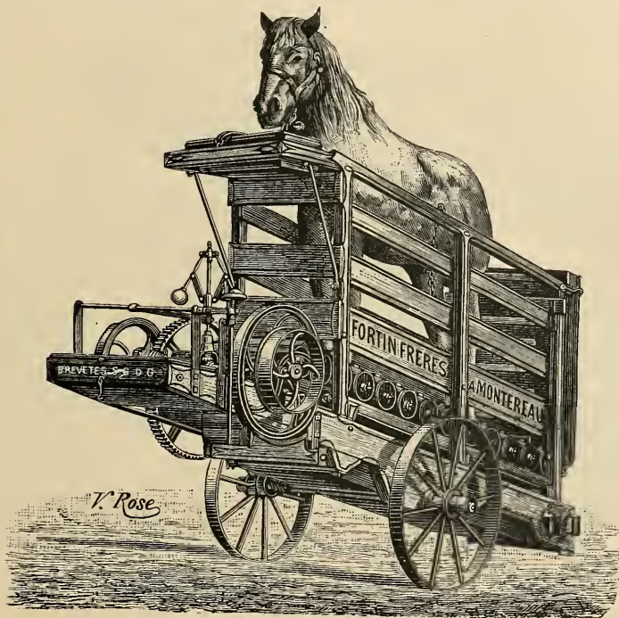
FIG. 577. — Manège locomobile à plan incliné (Fortin).
