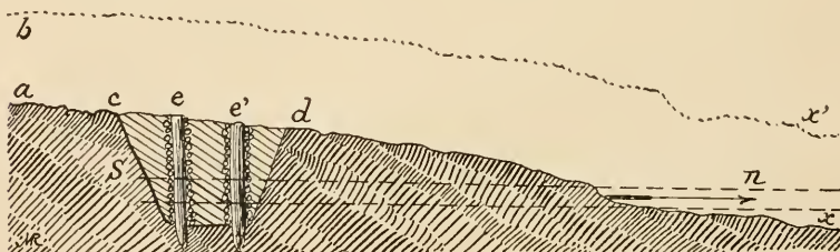
FIG. 317. — Coupe transversale d'un barrage souterrain.
