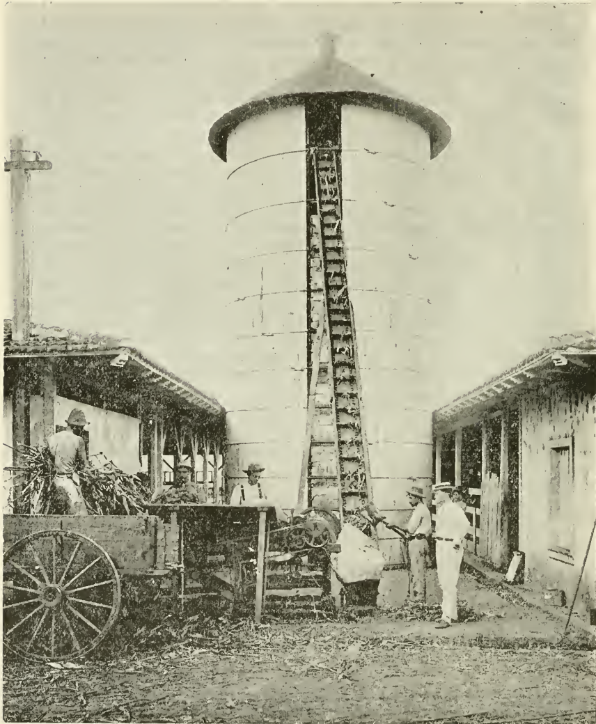
FIG. No. 2.—“Silo” y “Cortadora de Forraje” durante la operación del corte y elevación del forraje para su conservación.
