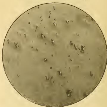
Fig. 19. — Acier au vanadium à carbure (C=0,120 ; Va=10,27). — Attaque à l'acide picrique. (G=200 d.)
