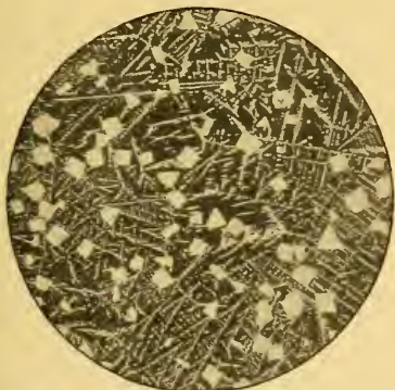
Fig. 31. — Antifriction industriel (Sn = 82,22; Sb = 11,36; Pb = 0,77; Cu = 5,58). Cubes de SbSn. Aiguilles de Cu 3 Sn. — Attaque à l'acide chlorhydrique. (G = 200 d.)
