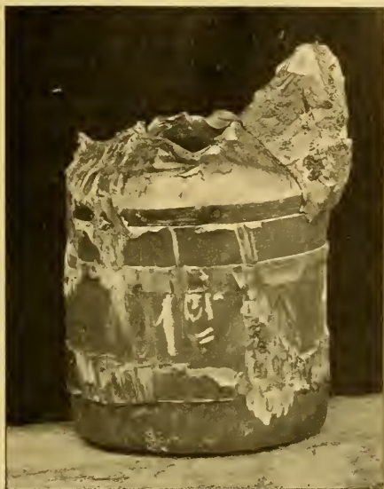
Fig. 6. — Culot d'un obus non coiffé après le tir de celui-ci sur plaque cimentée.
