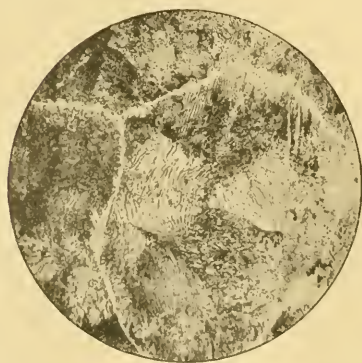
Fig. 5. — Acier hypereutectoïde (C = 1,05). Cellules bordées de cémentite blanche et remplies de perlite. — On notera ici les lamelles alternantes de la perlite. Attaque à l'acide picrique. (G = 200 d.)
