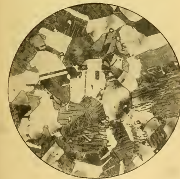
Fig. 14. — Acier au nickel polyédrique ( C=0,800 ; Ni=25 ). — On notera les plans de clivage des polyèdres. Attaque à l'acide picrique. ( G=300 d.)
