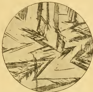
Fig. 10. — Austénite (blanche) et aiguilles de troostite-sorbite (noires). (G = 200 d.)
