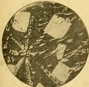
Fig. 32. — Antifriction industriel (Sn = 83,3; Sb = 11,1; Cu = 5,5). Cubes de SbSn. Aiguilles de Cu 3 Sn. — Attaque à l'acide chlorhydrique. (G = 200 d.)
