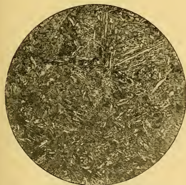
Fig. 13. — Acier au nickel martensitique ( C=0,120 ; Ni=15 ). — Attaque à l'acide picrique. ( G=300 d.)
