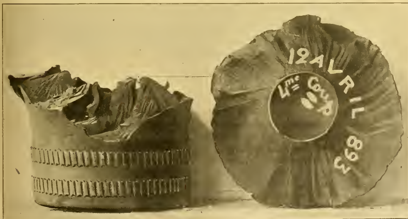
Fig. 7. — Aspect caractéristique d'un obus non coiffé après le choc sur plaque cimentée.
