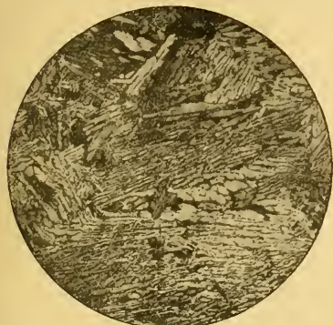
Fig. 30. — Laiton à l'aluminium (Cu = 70; Al = 5; Zn = 25). Même structure que le laiton (Cu = 60; Zn = 40). — At- taque à la solution ammoniacale d'oxyde de cuivre. (G = 50 d.)
