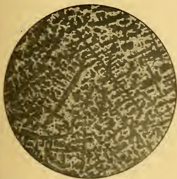
Fig. 24. — Bronze industriel (Cu = 87,3; Sn = 9,13; Zn = 2,25; Pb = 1,32. — Attaque à la solution ammoniacale d'oxyde de cuivre. (G = 50 d.)
