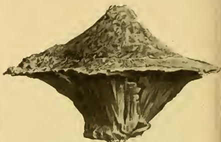
Fig. 4. — Effets produits par le choc sur plaque cimentée. Ogive d'un obus non coiffé. Vue d'ensemble de l'ogive déformée.
