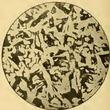
Fig. 7. — Acier demi-dur (C = 0,400). Perlite noire et ferrite blanche. — Attaque à l'acide picrique. (G = 200 d.)
