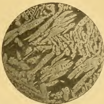
Fig. 27. — Laiton (Cu = 58; Zn = 42. Solution α + solution β (noire) . — Attaque à la solution ammoniacale d'oxyde de cuivre. G = 50 d.
