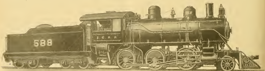
Fig. 2. — Locomotive type Mogul, construite en 1902. — Poids en service : 77 tonnes.
