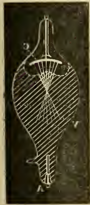
Fig. 1. — Production du faisceau cathodique et de l'espace obscur dans une ampoule de Crookes. — V, ampoule dans laquelle on a fait le vide; A, anode reliée au pôle positif, et C, cathode reliée au pôle négatif d'une bobine de Ruhmkorff.
