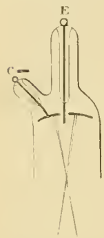
Fig. 12. — Coupe du faisceau cathodique émis par une cathode concave. — Il a la forme d'un cône creux. Lorsque le centre de la cathode est percé d'une ouverture dans laquelle passe une électrode E chargée positivement, la base du cône cathodique s'élargit.
