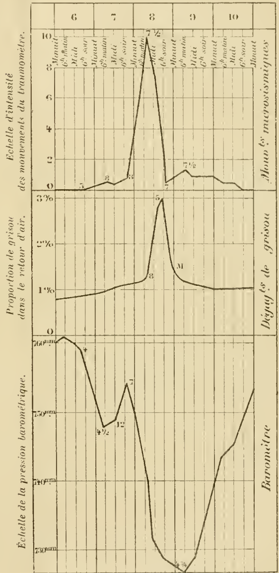
Fig. 1. — Diagramme chronologique des phénomènes barométriques, sismiques et grisouteux notes à la mine d'Hérin (Anzin), par M. Chesneau, du 6 au 10 décembre 1886.
