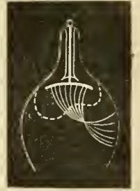
Fig. 2. — Déformation de l'espace obscur et déviation des rayons cathodiques par l'action d'un champ magnétique.
