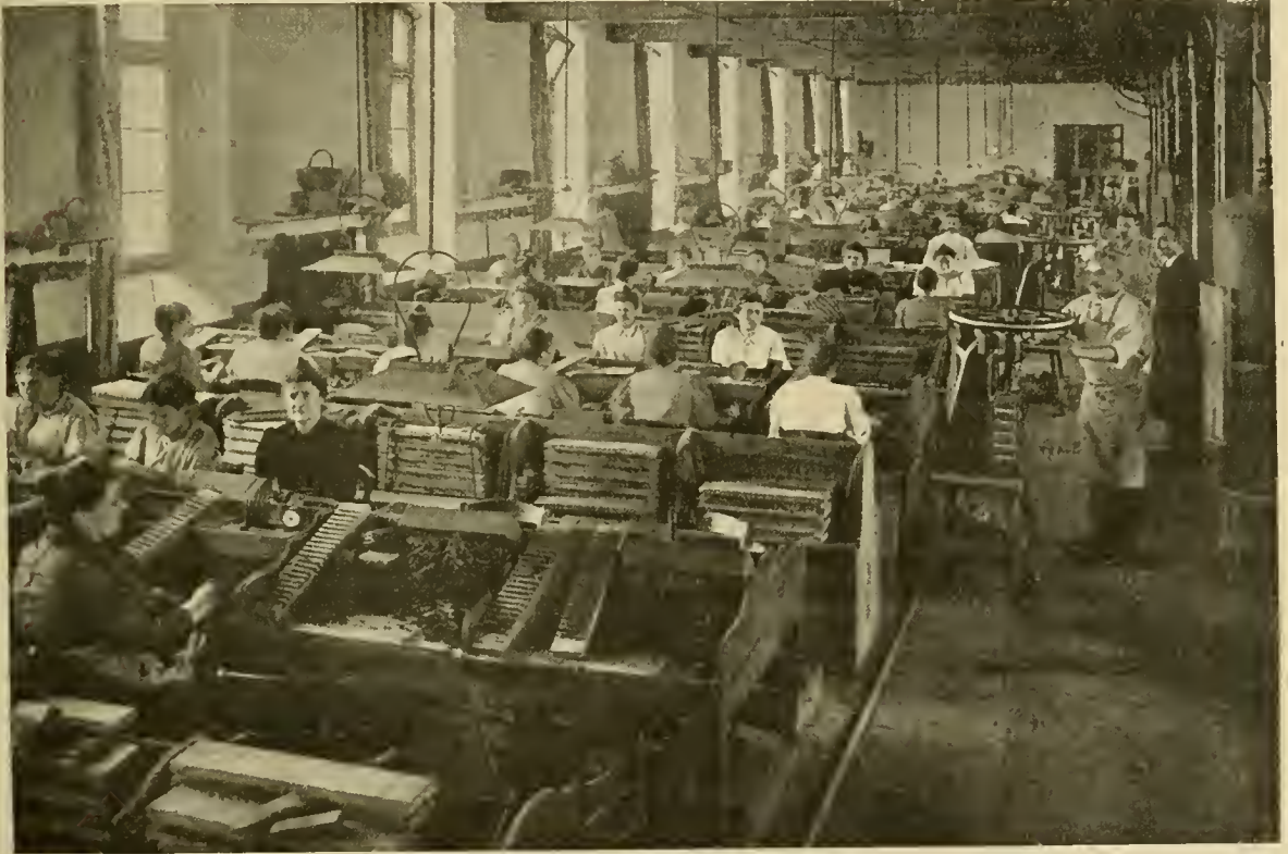
Fig. 4. — Atelier de confection des cigares à la Manufacture de Reuilly. — Au premier plan et au milieu, on aperçoit les deux parties. — mâle et femelle, — d'un moule-bloc. Les alvéoles de la partie femelle sont remplies par les poupées de cigares. En dehors des tables, des ouvriers donnent avec des presses à bras la pression nécessaire à un groupe de cinq blocs. Entre les poteaux, on voit les poêles à vapeur servant au chauffage de l'atelier.
