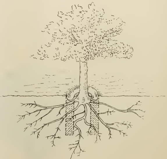
Fig. 1, Fehlerhaft angebrachter Dunggraben. Vom Verfasser für die „Monatshefte“ gezeichnet.
