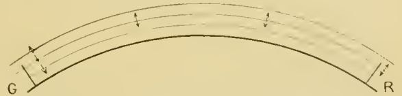
Fig. 4. — Preuve de la transmission des ondes par les surfaces équipotentielles entre deux stations G et R pour lesquelles la courbure de la terre empêche la transmission en ligne droite.
