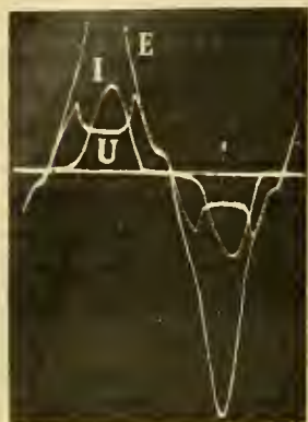
Fig. 19. — Courbe de l'arc alternatif criard entre charbons homogènes durs en circuit non inductif.
