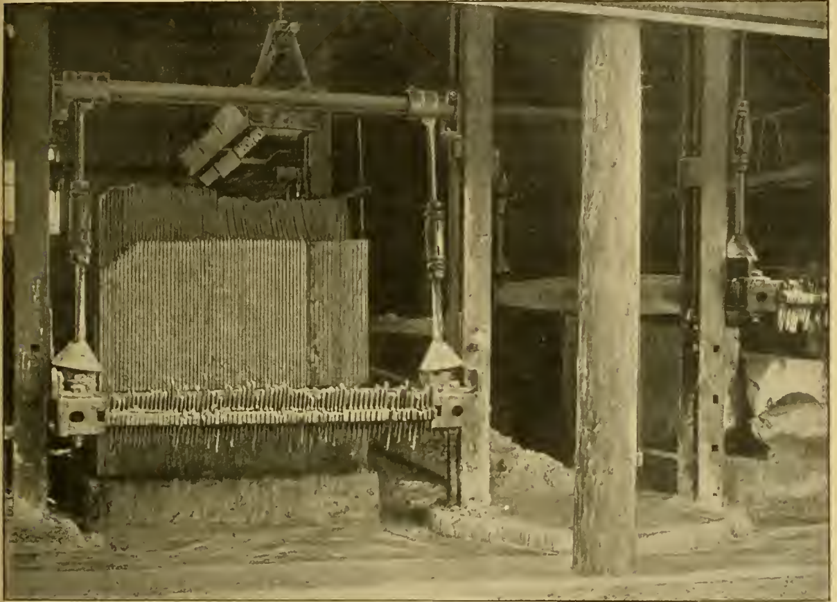
Fig. 9. — Châssis à scier ordinaire de la marbrerie Heurley, à Paris. (Photographie montrant la disposition des lames pendant le sciage d'un bloc.)
