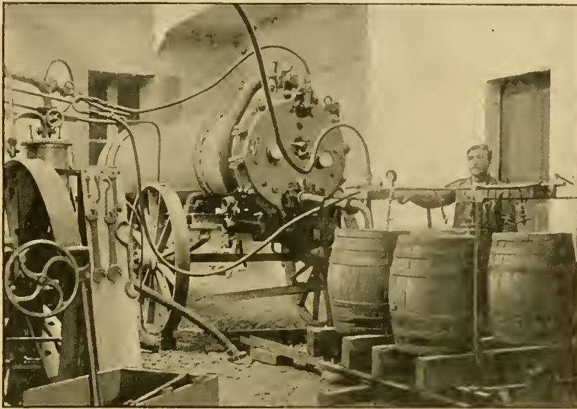
Fig. 2. — Stérilisation et transvasement aseptique du moût. — On voit au centre l'appareil de stérilisation Kuhn, monté sur roues. A droite sont placés les fûts qui recevront le moût stérile. A gauche, on aperçoit une partie du générateur de vapeur du moteur servant à envoyer l'air sous pression dans le filtre, dont on ne voit que la partie supérieure.
