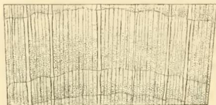
Fig. 251. Vergr. 3/1. Querschnittsansicht des Rothbuchenholzes. (Nach R. Hartig.) Vgl. p. 34.
