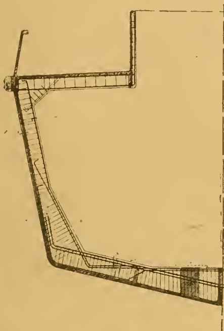
Fig. 6. — Demi-coupe de la carcasse d'un remorqueur de mer en ciment armé construit pour l'Amirauté britannique par la Wear Concrete Building Co.
