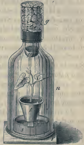
Fig. 28. Apparat zu Culturversuchen in kohlenstofffreier Luft. Die Glasglocke n ist luftdicht der abgeschliffenen Glasplatte r angepasst. Das dem Tubulus angepasste Glasrohr g enthält mit Kalilauge getränkte Bimssteinstücke, um die in die Glocke tretende Luft von Kohlensäure zu befreien. Die in der Porzellanschale s befindliche Kalilauge hat ferner die durch Athmung der Pflanze und aus dem Boden des Topfes t entstehende Kohlensäure zu absorbiren. Die Porzellanschale p hat einmal eventuell aus g abtropfende Kalilauge aufzufangen und kann zur Aufnahme von Chlorcalcium dienen, wenn die Luft in der Glocke nicht dampfesättigt sein soll.
