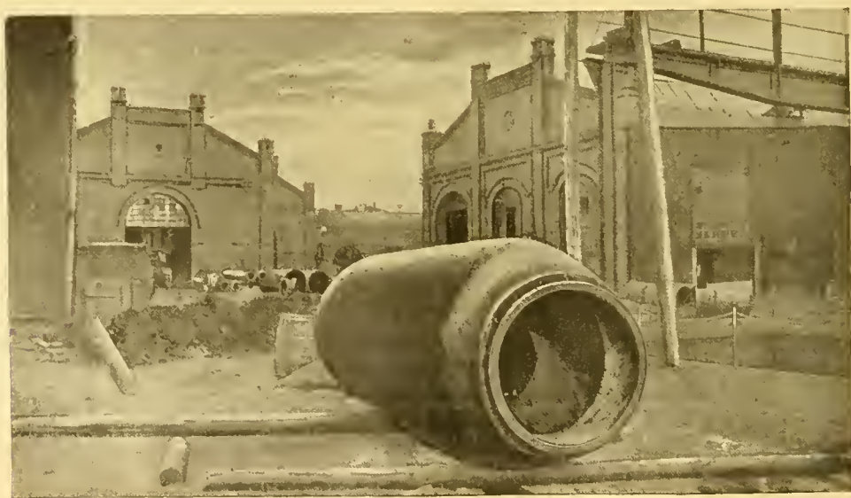
Fig. 10. — Pièce d'emboîtement de 2 tuyaux de diamètre différent entièrement soudée au gaz à l'eau.
