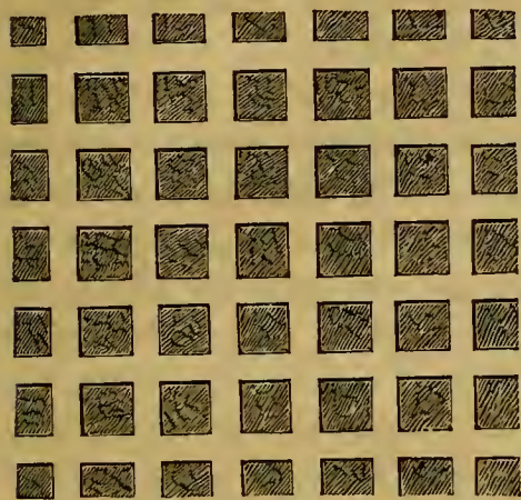
Fig. 7. BEWERKING DOOR GALERIJEN EN PIJLERS.
