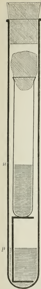
Fig. 88. BUCHNER'S Anaeroben-Röhre. Bei p die Pyrogallol-Lösung, darin das Drahtbänkchen, auf diesem das Reagensglas mit dem beimpften Nährboden ( n ). Etwas verkleinert. Nach BUCHNER.
