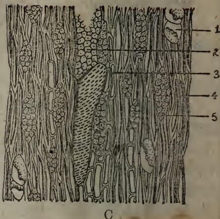
图45. A. 樟木的横切面 B. 半徑性縱切面 C. 切綫性縱切面 1. 油細胞 2. 导管 3. 木細胞 4. 木纖維 5. 髓綫
