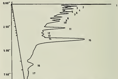
FIGURA 5. Análisis químico del efluente industrial. El análisis se llevó a cabo mediante cromatografía de gas con detector de captura electrónica. Los peaks numerados del 2 al 15 muestran la presencia de compuestos organoclorados, probablemente generados en los procesos químicos de blanqueamiento de la celulosa.
