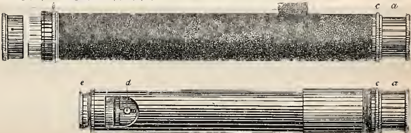
Das Tele-Mikro-Bioskop. Oben: das ganze Instrument, als Fernrohr und Bioskop benutzbar. Unten: der herausgezogene Teil, als Mikroskop benutzbar.
