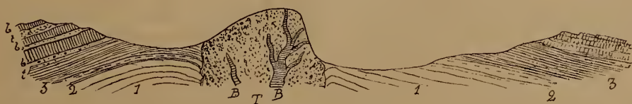
Fig. 3. — Coupe à travers le Binn de Burntisland. 1, grès; 2, calcaires; 3, schistes, etc.; b, b, basaltes interstratifiés; t, t, lits de tufs; T, tufs de la grande cheminée du Burntisland; B, apophyses basaltiques.
