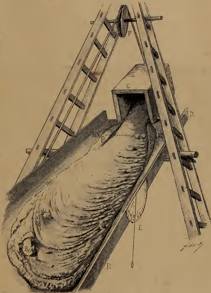
Fig. 2. — Autre appareil destiné à l'imitation expérimentale des épanchements boueux. — C, réservoir pour la boue. F, corde passant sur une poulie et qui permet la bascule du réservoir. RR, table sur laquelle se fait l'épanchement. E, échelle. B, bloc rocheux charrié par la boue. — Même échelle que la figure 1.
