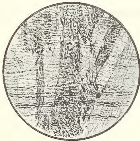
Fig. 2. — Lame mince vue au microscope entre les nichols croisés du dépôt de source de la mine de Carmaux. — Grossissement : 60 diamètres.
