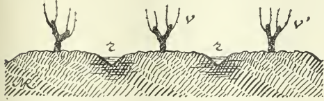
Fig. 114. — Coupe en travers d'un vignoble arrosé par infiltration.
