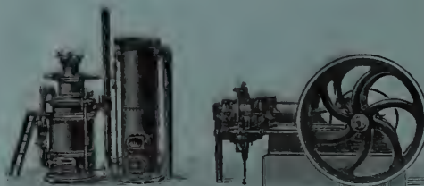
Installation à gaz pauvre.
