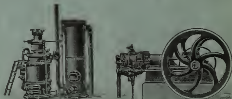
Installation à gaz pauvre.
