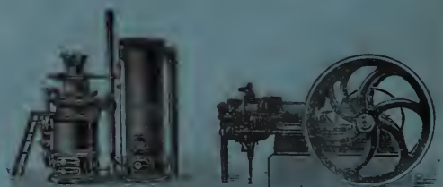
Installation à gaz pauvre.
