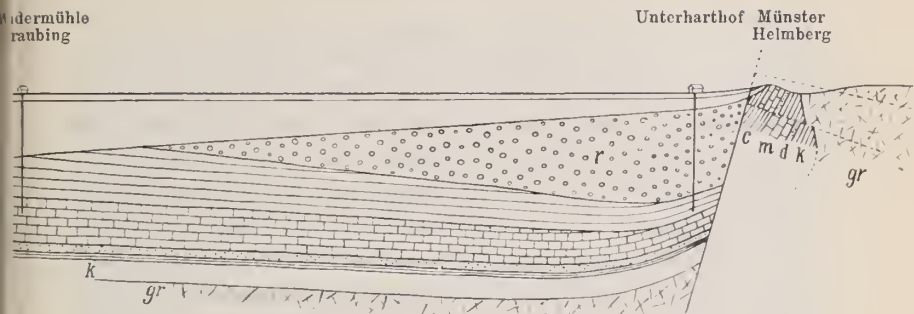
Fig. 1. l Alluvium und Diluvium, t Miocän, c obere Kreide, m oberer Jura, d Dogger, l Lias, k obere Trias, r Rotliegendes, gr Granit. Maasstab 1:50000.
