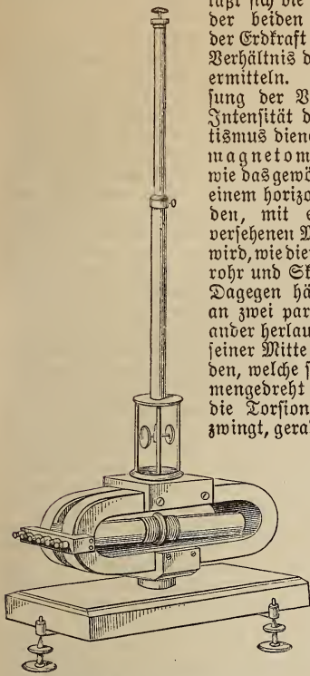
Fig. 2. Magnetometer (zugleich Spiegelgalvanometer).
