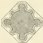
7 Grundriss eines Pfeilers
