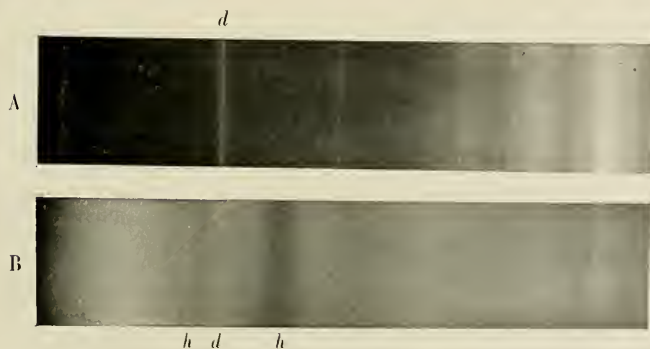
Fig. 2. — A, spectre solaire normal; B, spectre de la solution sanguine sulfurique, montrant en hh les bandes de l'hématoporphyrine; d , d , raie sodique.
