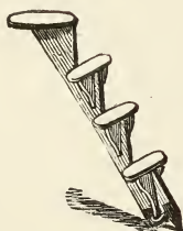
Fig. 20. — Disposition des échelons et des supports.
