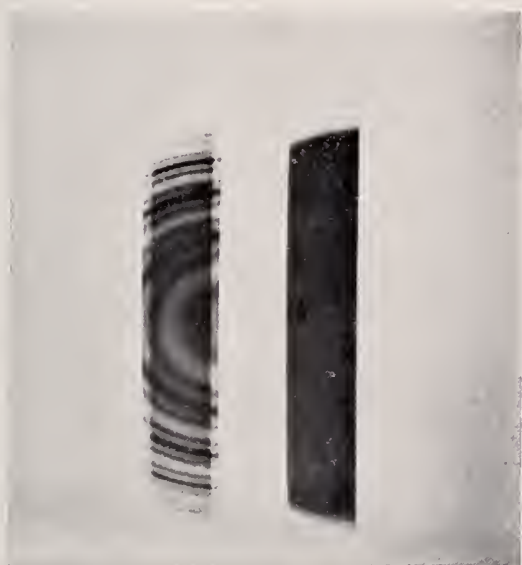
1. Les deux raies jaunes du mercure dans un champ magnétique. Fente très large. La raie verte est surexposée. Etalon 5 mm. Intensité du champ environ 5000 Gauss.
