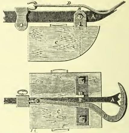
Fig. 201. — Élévation et plan du levier Ménard.
