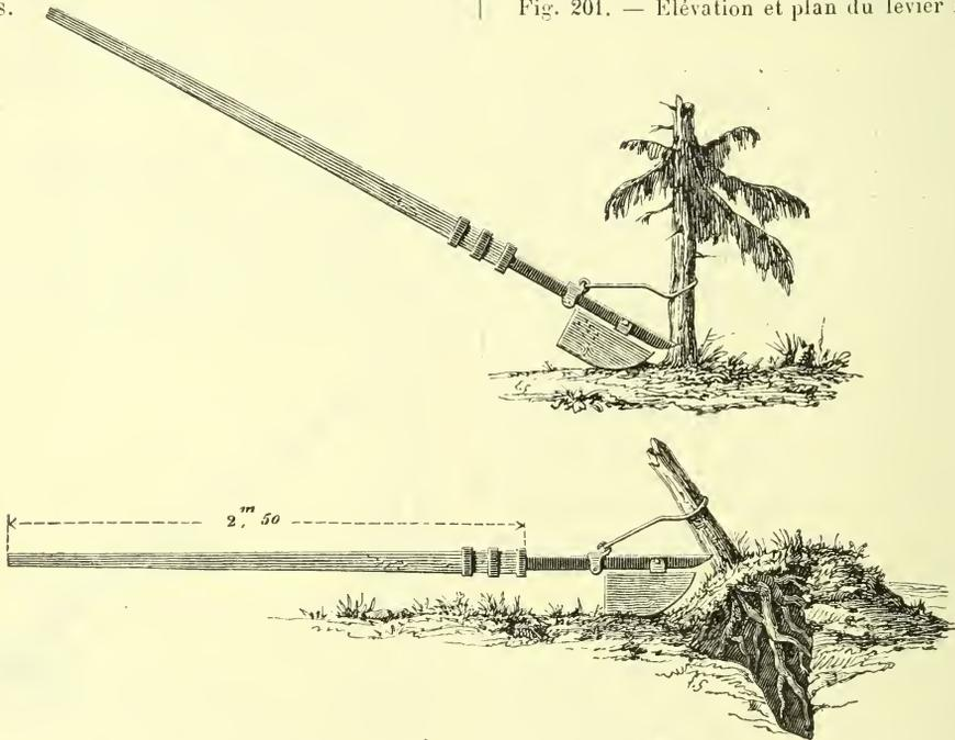
Fig. 202. — Fonctionnement du levier Ménard.
