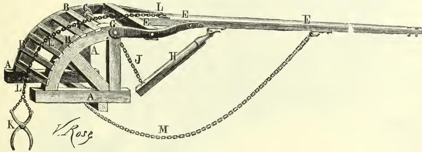
Fig. 215. — Machine Godeau pour l'arrachage des souches.
