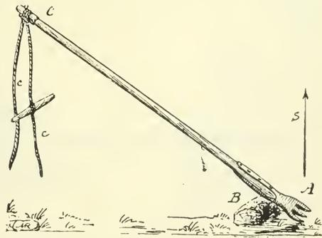
Fig. 199. — Levier à fourche pour l'arrachage des souches.
