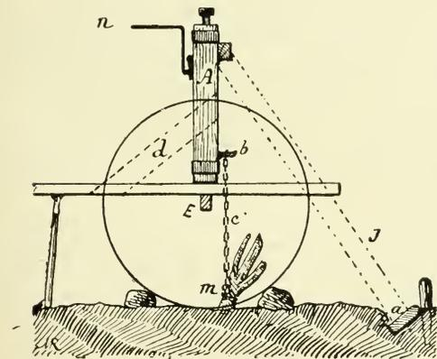
Fig. 210. — Montage d'un cric pour l'arrachage des souches.
