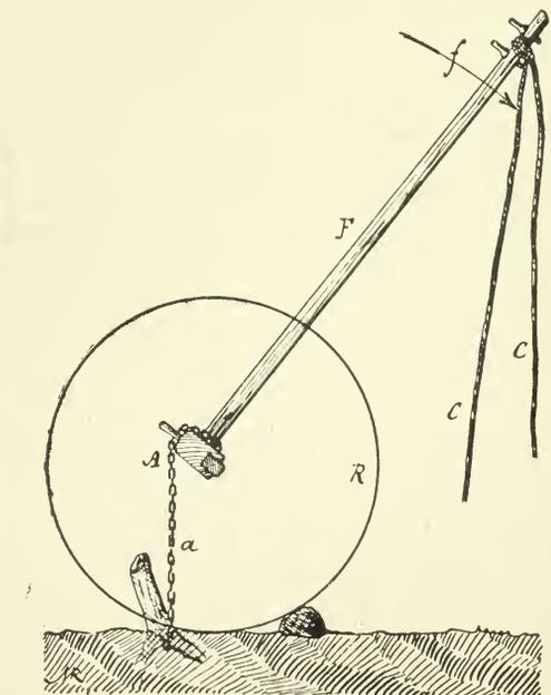
Fig. 211. — Emploi du fardier pour l'arrachage des souches.
