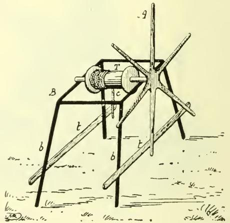
Fig. 207. — Treuil pour l'arrachage des Vignes.
