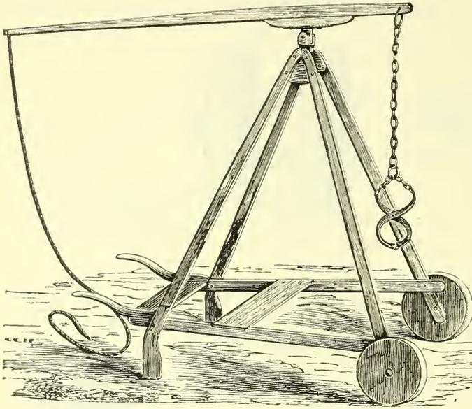
Fig. 206. — Machine à arracher les souches, F. Lamblin.
