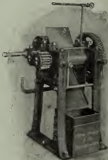
Laminoir laveur pour caoutchouc brut commandé à la main et par courroie.
