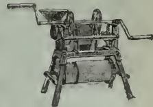
L'Oriental décortiqueur à bras, permettant en une seule opération, de séparer les balles, le paddy et le riz décortiqué
