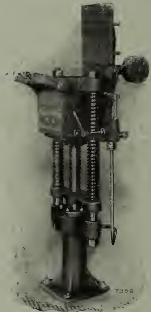
Presse hydraulique pour blocs de caoutchouc brut
