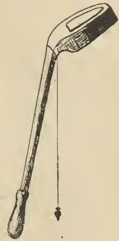
Fig. 19. — Gouge munie d'un fil à plomb pour le tracé des saignées par rigoles collectrices verticales.
