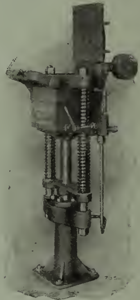
Presse hydraulique pour blocs de caoutchouc brut.
