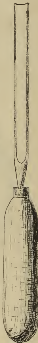
Fig. 30. — Gouge droite à lame concave, grandeur naturelle.
