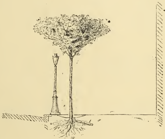
Fig. 59. — Coupe transversale d'un trottoir planté.
