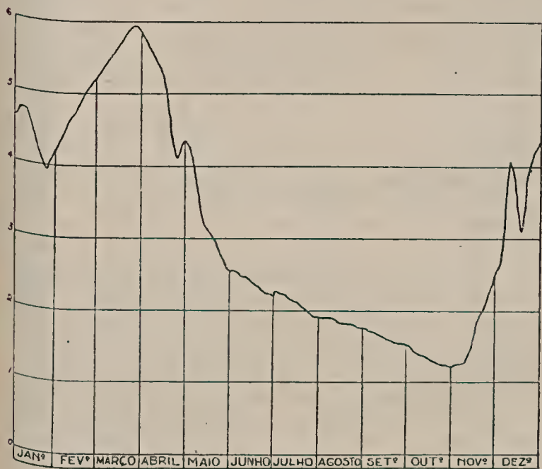
Fig. 9 — Descarga do São Francisco em Joazeiro durante 1929.
