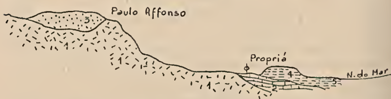
Fig. 8 — Secção normal á costa ao longo do rio. 1 — Archeano. 2 — Sério do Baixo São Francisco. 3 — Sério Tocaratú. 4 — Sério dos Taboleiros. 5 — Quaternario.
