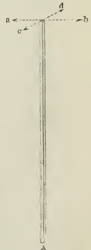
Fig. 17. Zusammengelegte Schwingung eines Stäbchens.
