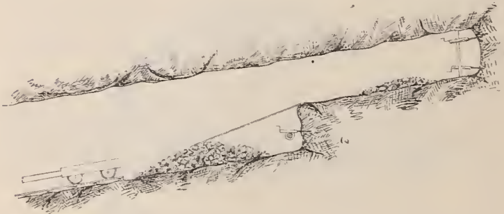
Fig. 17. — Coupe longitudinale montrant les fronts d'attaque et d'élargissement.
