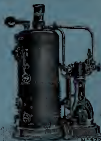
Machine-Pilon et Chaudière.
