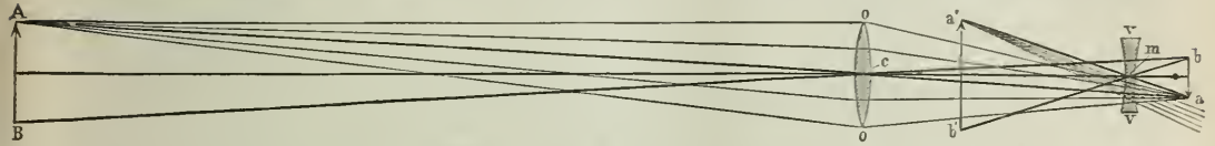
Fig. 2. Wirkung des Galileischen Fernrohrs.
