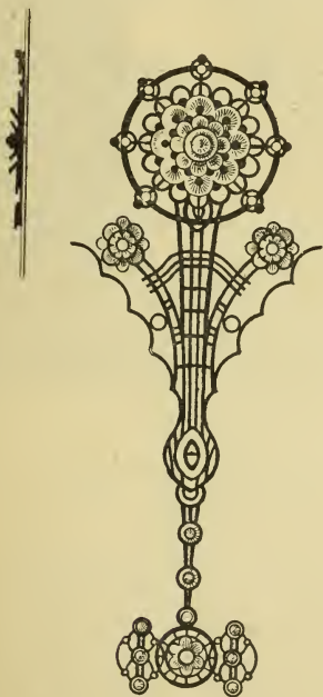
Fig. 201. — Dahlia en treillage sur la facade latérale de la grande serre; — en haut, coupe du profil.
