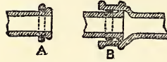
Fig. 46. — Section d'un joint annulaire en caoutchouc. A) Joint avant. — B) Joint après jonction des tuyaux.
